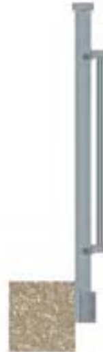
Pose en nez de dalle
